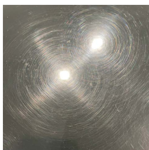
Känslig mörk, blank yta 80GU efter Martindale-test
