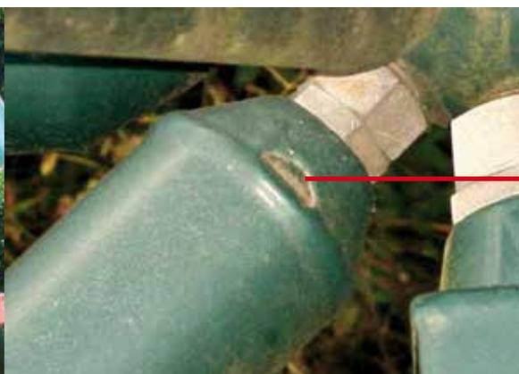
Nessuna corrosione sotto il film anche dopo anni di esposizione
