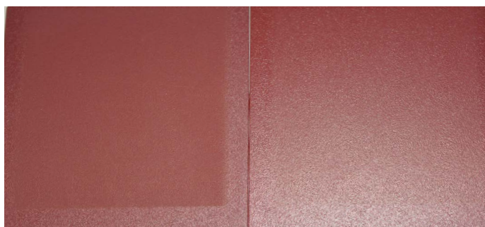
Retención de brillo: envejecimiento acelerado QUVB 600h - Alesta® AP izquierda/Alesta® SD derecha
